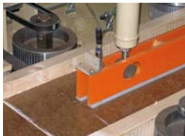
Кромки сделаны из высушенной в сушилке, отсортированной по прочности и скрепленной клепками древесины мягких пород, что гарантирует надежность и высокое качество и четко определенные механические свойства. Стенки сделаны из древесного волокна, скрепленного по длине профилем
