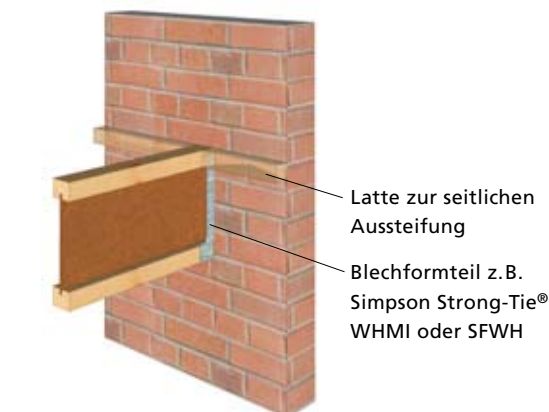
F5 Mauerwerksanschluss mit HWS® Blechformteil
