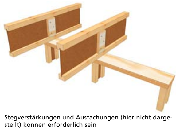
F10 Durchlaufträger auf Innenwand
